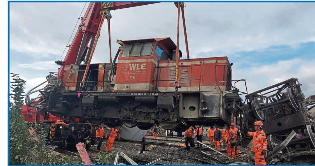
Bergung mit schwerem Gerät: Die verunglückte Diesel-Lok wiegt 54 Tonnen. Am Mittwochabend hing sie am Haken des Bergungskrans, wurde aufgerichtet und danach wieder in die Spur gesetzt. FOTO: KOSSACK
